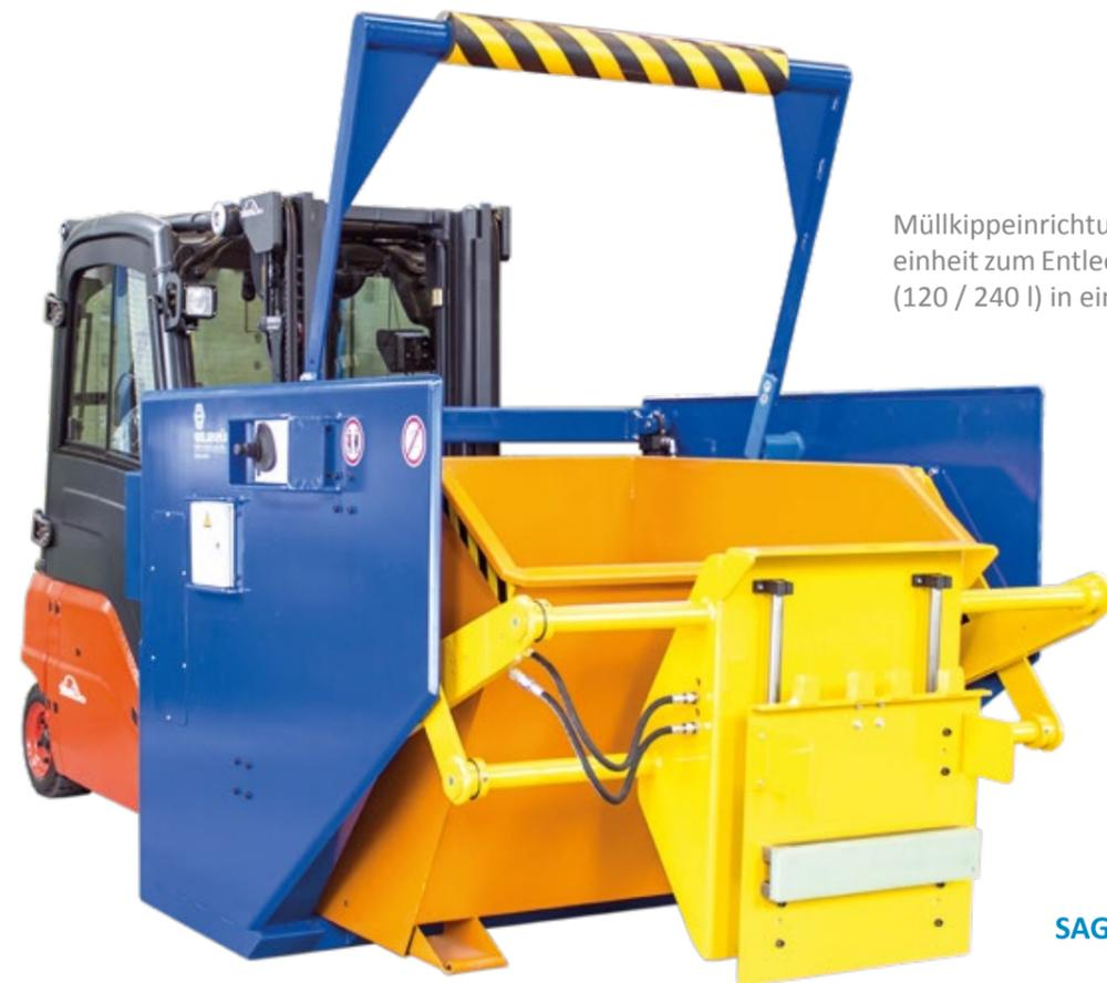
Müllkippeinrichtung als Anbaueinheit zum Entleeren von Tonnen (120 / 240 l) in eine Mulde
