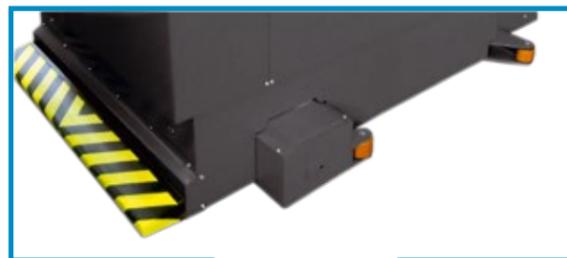
Sicherheitsschaltleiste in Steuerung integriert
